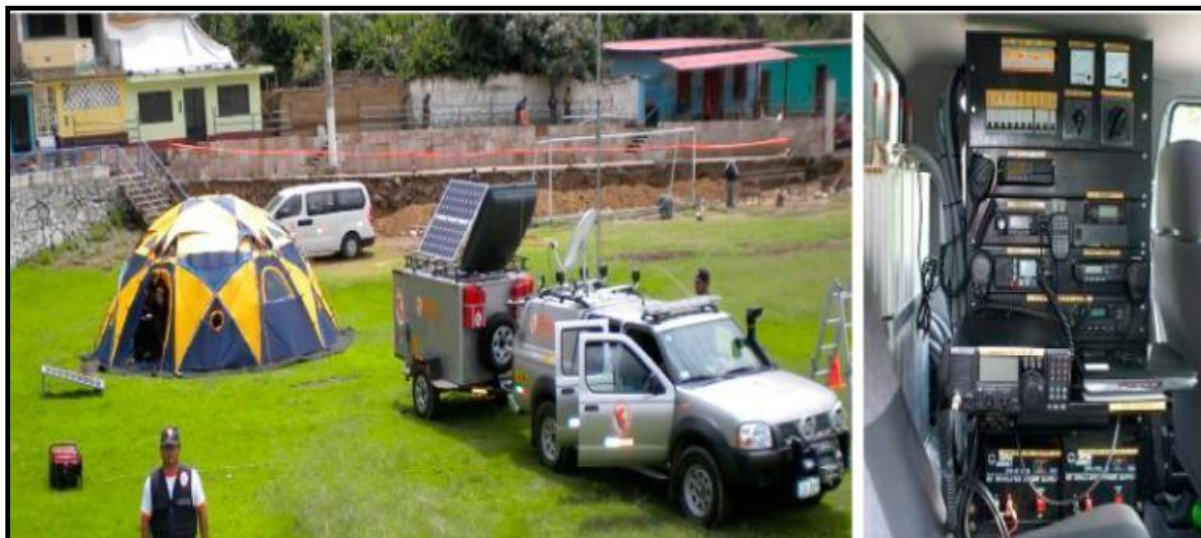
Figura 2.13 CENTRO MÓVIL CON EQUIPOS DE RADIO HF Y VHF Fuente: INDECI
