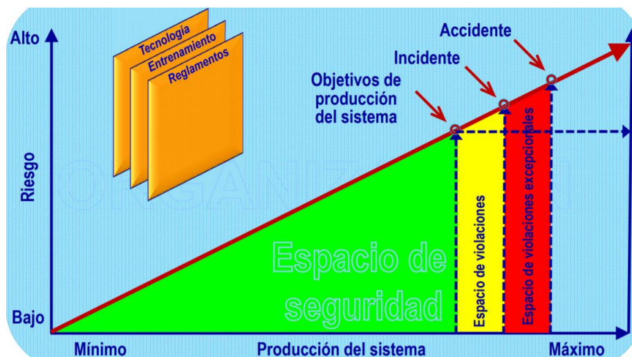
Figura 13. Cómo afecta violar las normas
