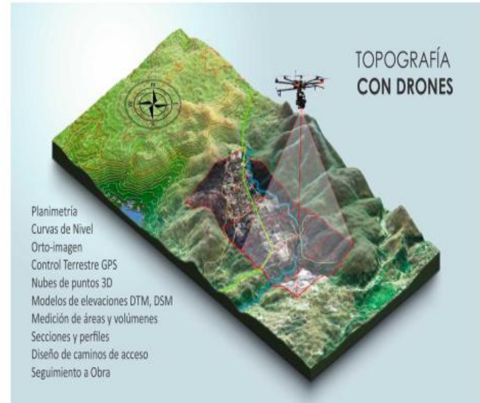
Figura N° 19 Implementación de drones en el mapeo topográfico
